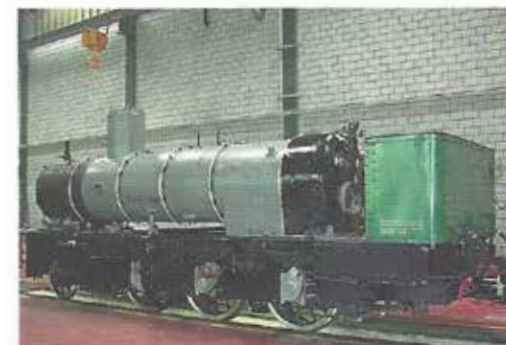
Der neue ölgefeuerte Kessel ist eingebaut
