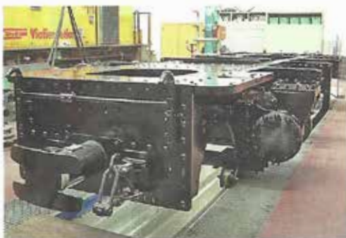
Der umgebaute und frisch revidierte Rahmen in Landquart
