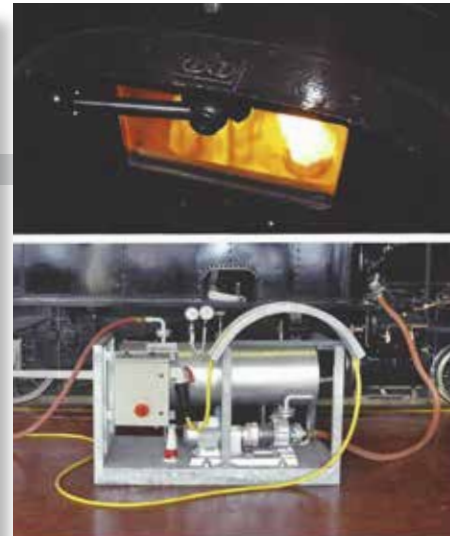
linke Seite: Die Dampflok «Heidi» während ihrem «Rollout» aus der Betriebswerkstätte von Samedan. Foto: Christian Wehr oben: Der leuchtendgelbe «Pilotbrenner» in der Feuerbüchse. unten: Eine elektrische Vorheizanlage wärmt das Wasser vor. Dadurch wird ein langes Vorheizen der Dampflok mit Kohle überflüssig.
