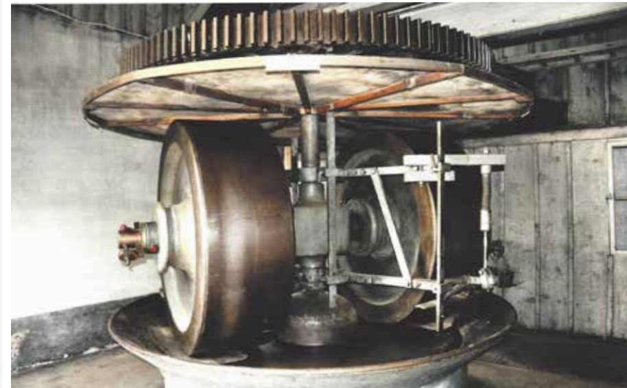
Der sogenannte Läufer (Kollergang) in der Churer Pulvermühle mahlte die
