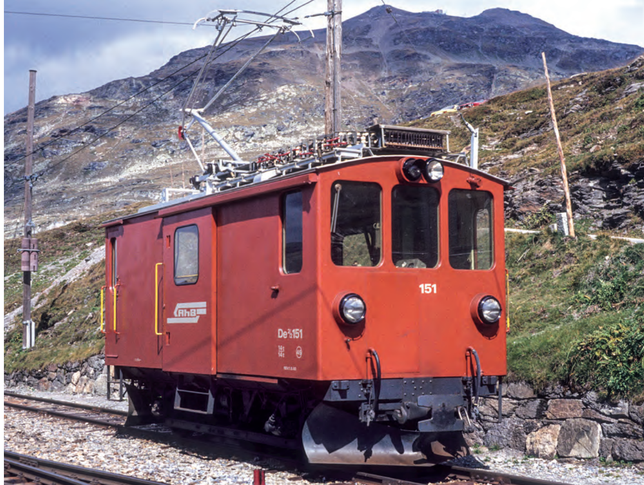
Verblechter Kasten, Einholmstromabnehmer und oxydroter Anstrich: In diesem Zustand präsentierte sich der De 2/2 151 ab 1980 während rund zehn Jahren. Ospizio Bernina, 14. September 1981. Archiv RhB
