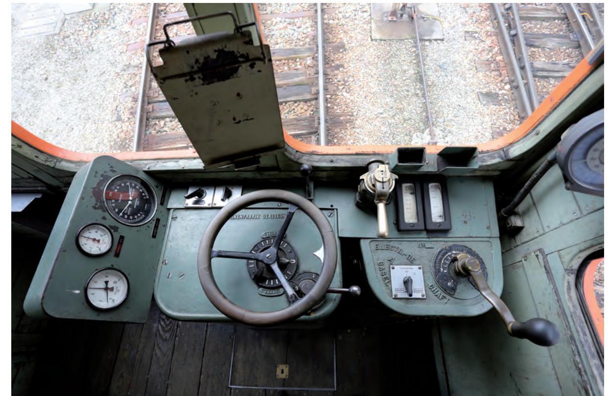
Rudimentär: Der Führerstand mit dem hölzernen Handrad des Fahr-/Bremskontrollers, dem Druckluft-Rangierbremsventil, dem Schalter für die Magnetschienenbremse und dem Controller der Vakuumbremse.
